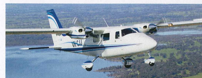
NEU IM PROGRAMM: Die P68 gibt es nun auch mit Einziehfahrwerk (Foto ganz oben). Sie firmiert unter der Bezeichnung Vr.
